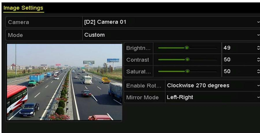
Figura 13-4 Interfaz de configuración de imagen
