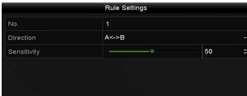
Figura 9-5 Establecer las reglas de detección de cruce de línea
