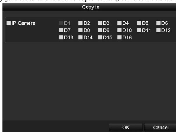
Figura 12-17 Copiar la configuración a otras cámaras
