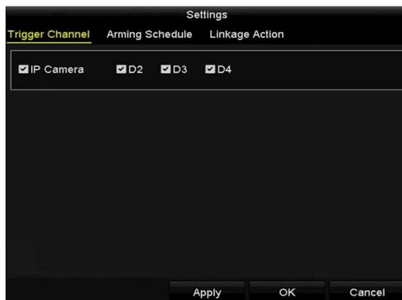
Figura 5-18 Establecer la cámara de activación de la alarma VCA
