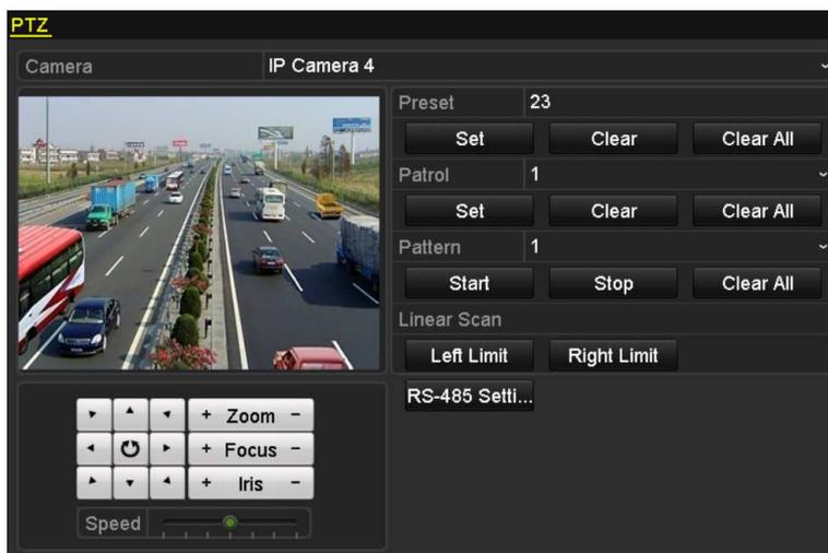
Figura 4-8 Configuración PTZ
